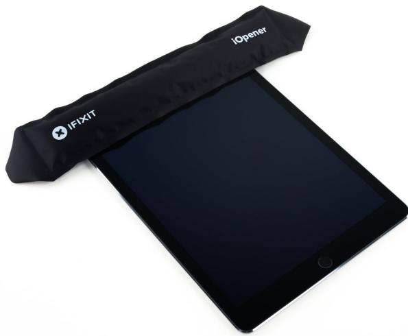
❶ Les étapes suivantes impliquent l'utilisation d'un iOpener pour ramollir l'adhésif qui maintient le panneau frontal en place. Lorsque vous utilisez l'iOpener, assurez-vous de ne pas le laisser chauffer au micro-ondes pendant plus de 30 secondes.
