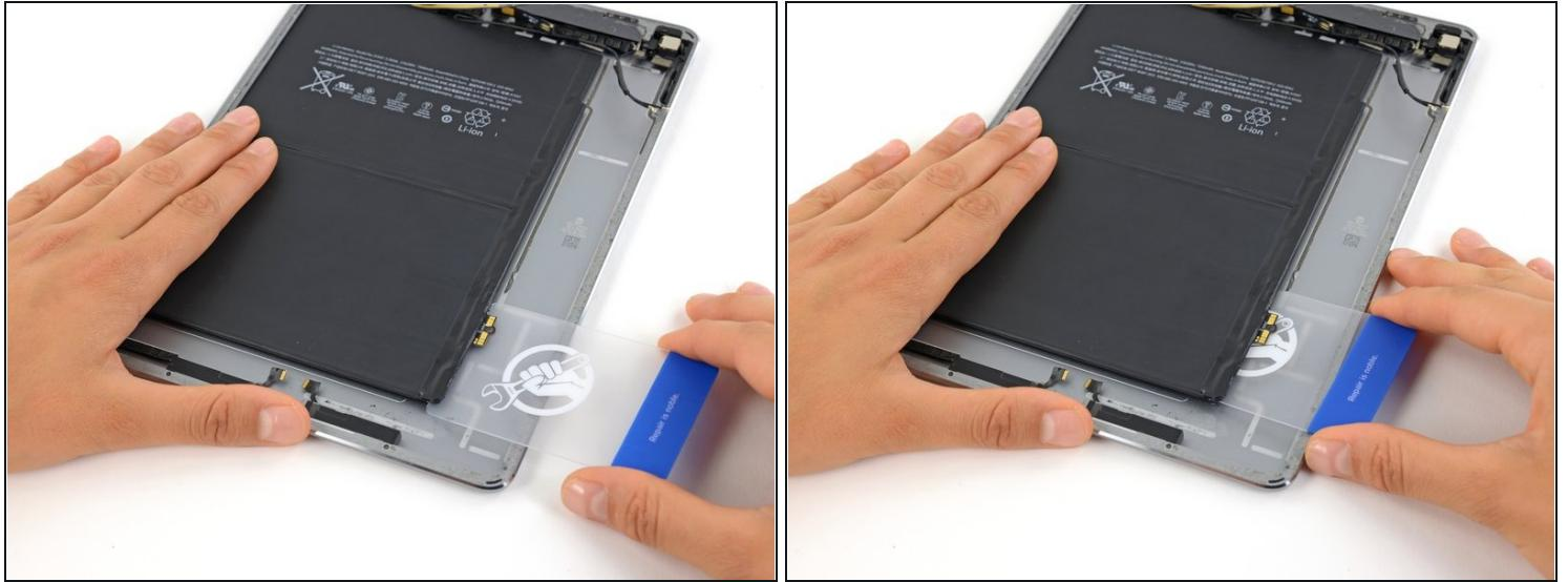
⚠ Tout au long de la procédure suivante, vous allez glisser de fines cartes plastiques entre la batterie et la coque arrière de l'iPad, pour décoller l'adhésif de la batterie. Veillez à manipuler les cartes aussi à plat que possible pour éviter de plier la batterie, ce qui pourrait l'endommager et laisser s'échapper des produits chimiques dangereux.
